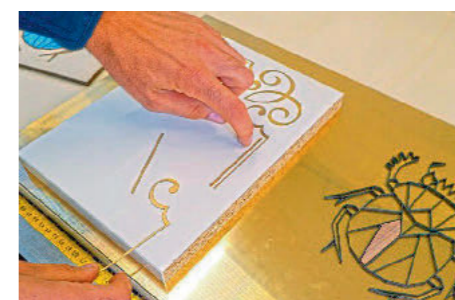
/ Mit einer Lasermaschine lässt sich so präzise arbeiten, dass das Material, welches eingelegt werden soll exakt in das identisch vertiefte Trägermaterial passt.
