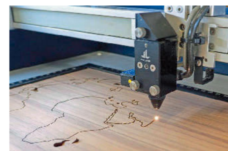
/ Durch die berührungslose Bearbeitung und den geringen Durchmesser des Laserstrahls ist es möglich, fast sämtliche Formen und Konturen zu erstellen.
