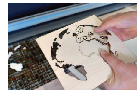
/ Ist die Laserbearbeitung abgeschlossen, können die ausgeschnittenen Teile einfach entnommen werden. So, wie bei einem Puzzle, das auseinandergebaut wird.
