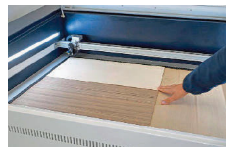
/ Um die Absaugleistung von unten zu optimieren und dadurch Schmauchspuren zu minimieren ist es clever, den ganzen Arbeitstisch mit Material abzudecken.
