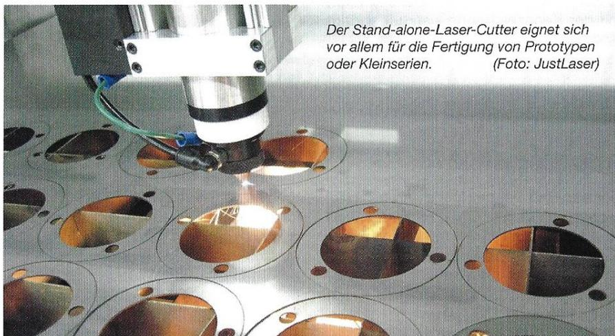
Der Stand-alone-Laser-Cutter eignet sich vor allem für die Fertigung von Prototypen oder Kleinserien. (Foto: JustLaser)
